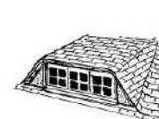
Lucarne en trapèze ou rampante à jouées biaisées (couverture en bardoux d'asphalte)
