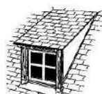
Lucarne rampante ou en chien couché
