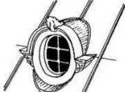
lucarne dite œil-de-boeuf, à encadrement et habillage en zinc façonné
