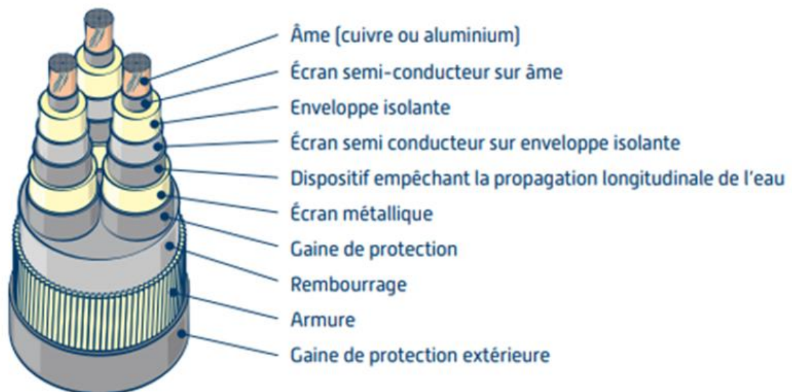
Figure 8 : Schéma de principe d'un tri-câble sous-marin. Source : RTE
