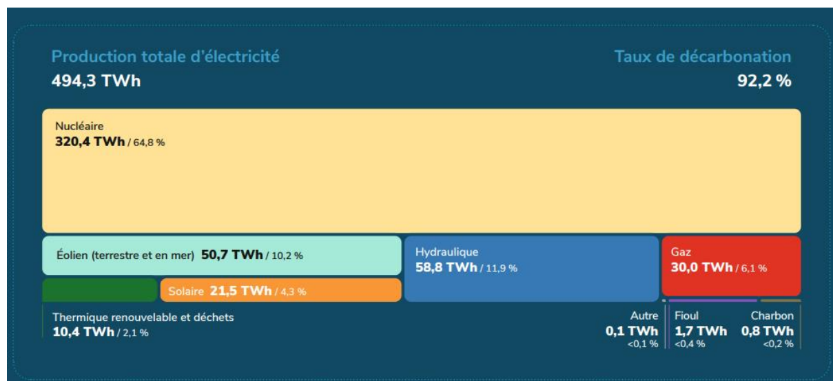
Figure 2 : Répartition de la production d'électricité par source (source : bilan électrique 2023, RTE)
