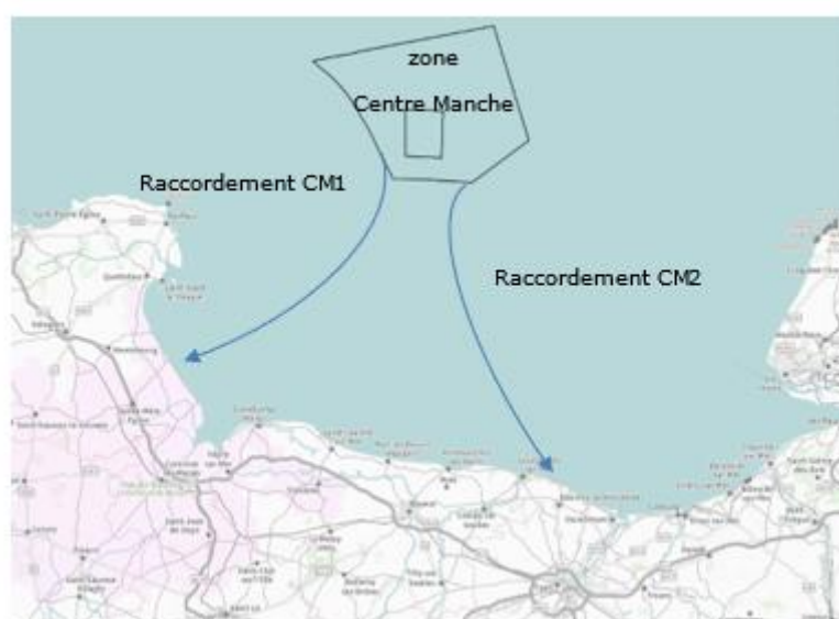
Figure 4 : Stratégie de raccordement des projets éoliens de la zone Centre Manche. Source : RTE
