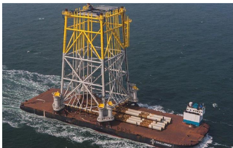
Figure 14 : Exemple de transports de pieux et de la sous-structure sur une barge. Source : DNV
