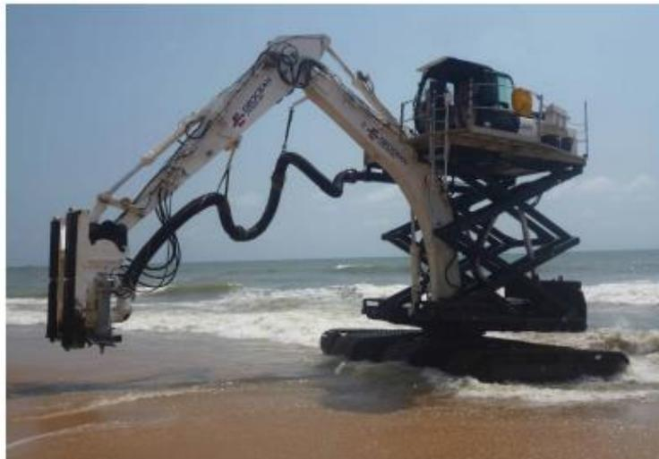
Figure 17 : Exemple de pelle excavatrice en zone de déferlement. Source : Starfish
