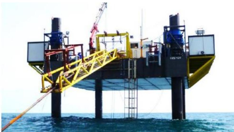
Figure 16 : Exemple de plateforme jack-up pour assistance à forage. Source : HDI
