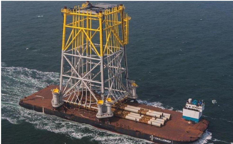
Figure 14 : Exemple de transports de pieux et de la sous-structure sur une barge. Source : DNV
