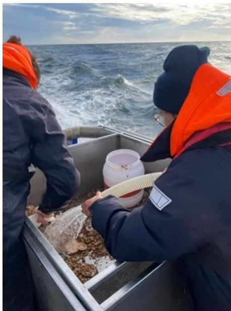
Figure 25 : Tamisage de sédiment fin de récupérer la faune sur des tamis à ouvertures circulaires de 2 et 1 mm dans le cadre du suivi du compartiment « Habitats benthiques ».
