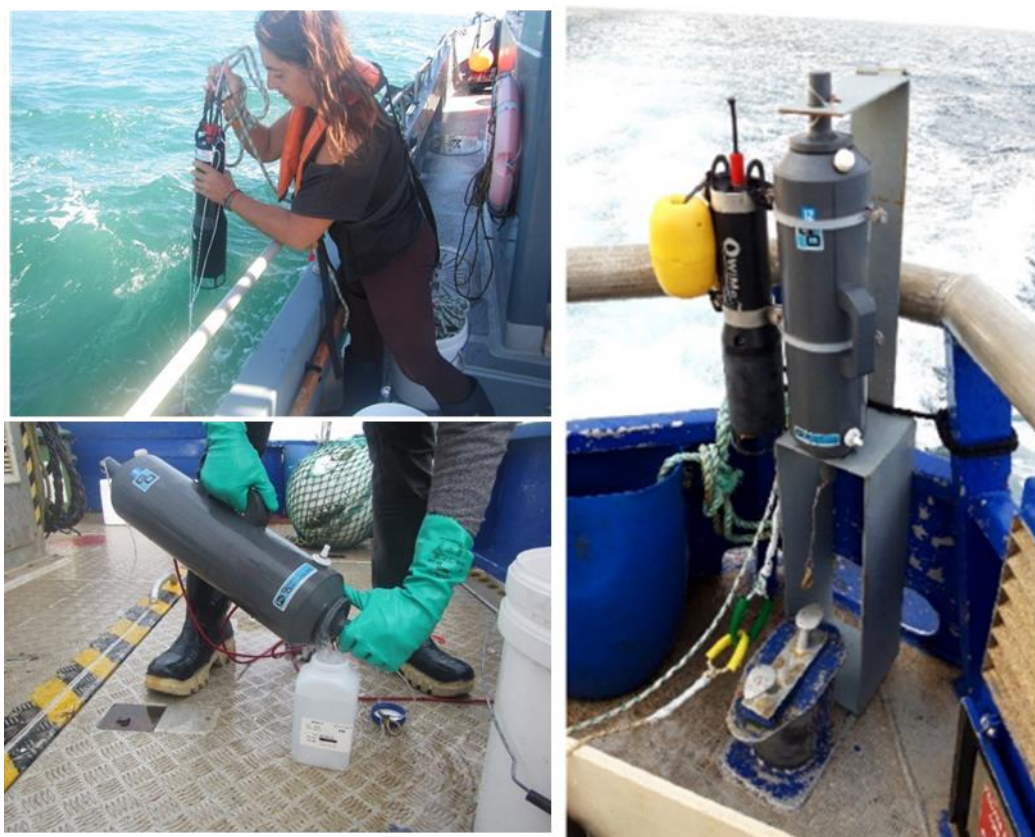
Figure 4 : Déploiement des sondes multiparamètres WIMO et des bouteilles Niskin pour le suivi de la qualité de l'eau (à gauche : TBM environnement ; à droite : SINAY)
