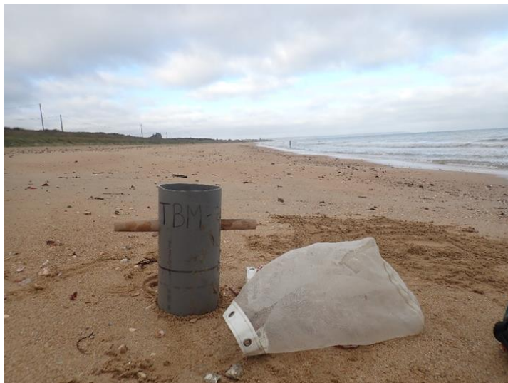
Figure 18 : Carottier à main et tamis pour l'échantillonnage des communautés benthiques des substrats meubles en zone intertidale
