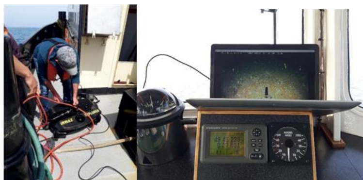
Figure 26 : Déploiement du Deep Tracker Revolution par le responsable de Irwaz Explorer (à gauche) et écran de contrôle en direct disponible pour l'expert de Sinay en cabine de pilotage (à droite) dans le cadre du suivi du compartiment « Habitats et peuplements benthiques ».
