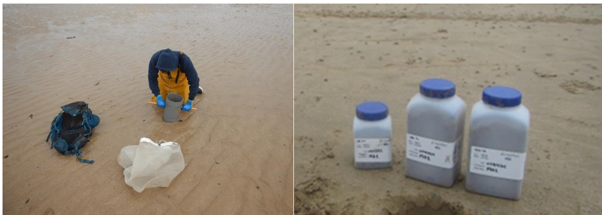
Figure 2 : Carottier à main et flaconnage pour les analyses physico-chimiques.
