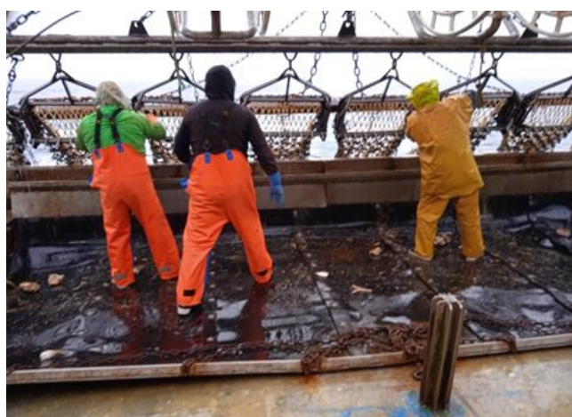
Figure 30 : Drague à coquilles utilisés pour les échantillonnages le long des raccordements par TBM.
