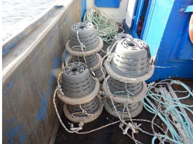
Figure 31 : Filières de casiers à bulots utilisés pour les échantillonnages le long des raccordements par TBM.
