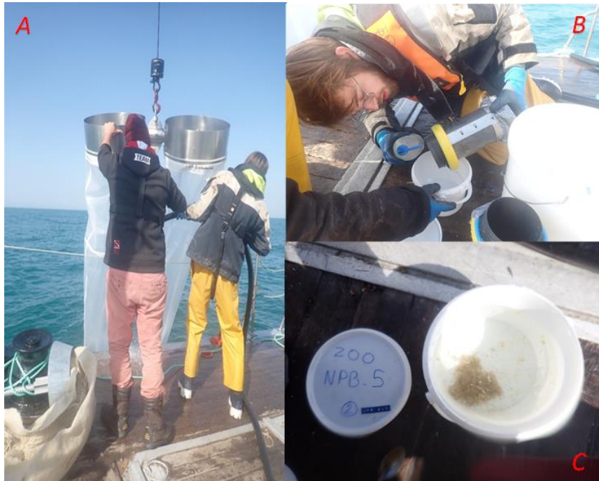
Figure 15 : Rinçage du filet Bongo (A) puis collecte du zooplancton dans le collecteur (B) et exemple du conditionnement (C)
