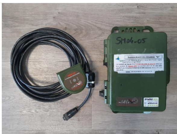
Figure 64 : Enregistreur automatique « passif » de type SM4BAT (à gauche) et exemple de résultats obtenus toutes espèces confondues (à droite) - Sources : TBM environnement/Ecosphère
