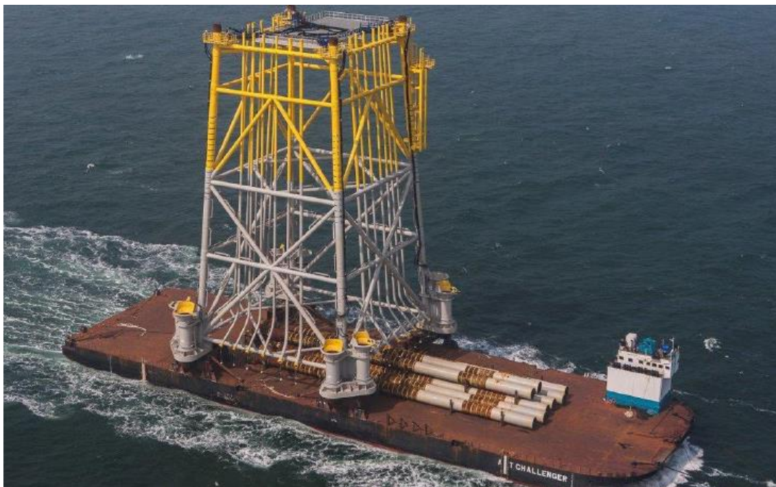
Figure 6 : Exemple de transports de pieux et de la sous-structure sur une barge. Source : DNV
