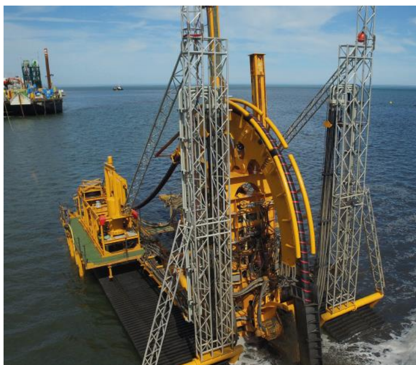
Figure 20 : Exemple d'outil hybride – Vertical Injector « Moonfish ». Source : RTE
