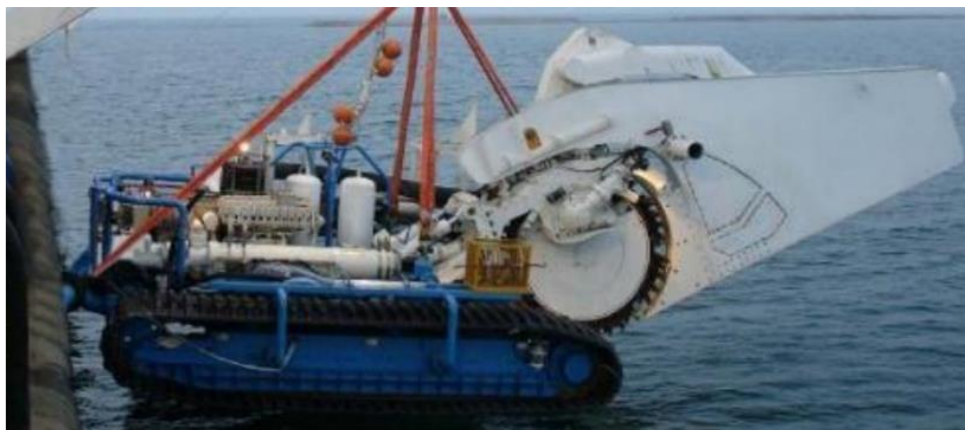
Figure 19 : Trancheuse mécanique à roue. Source : RTE
