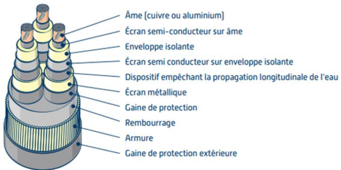
Figure 3 : Schéma de principe d'un tri-câble sous-marin. Source : RTE
