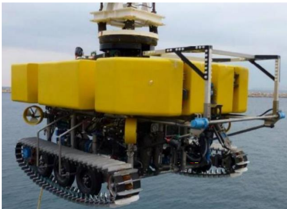
Figure 18 : Engin d'injection d'eau. Source : RTE
